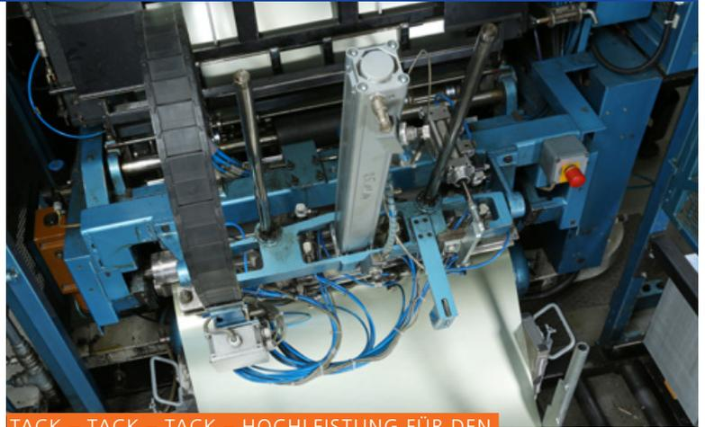
TACK – TACK – TACK – HOCHLEISTUNG FÜR DEN SCHMIERSTOFF Schrittsganggetriebe führen die bedruckten Tafeln dem kombinierten Stanz- und Tiefziehprozess zu.
