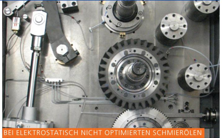
BEI ELEKTROSTATISCH NICHT OPTIMIERTEN SCHMIERÖLEN können gefährliche elektrische Ladungen entstehen.
